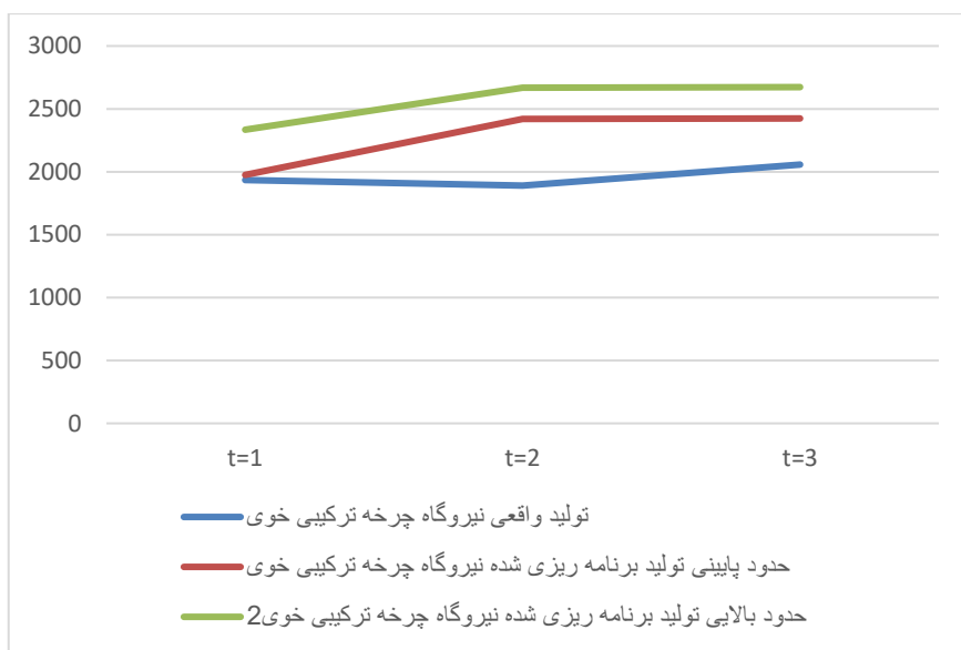
نمودار ۱۰. تولید سالانه الکتریسیته برنامه ریزی شده و واقعی نیروگاه چرخه ترکیبی خوی بر حسب هزار مگاوات ساعت
