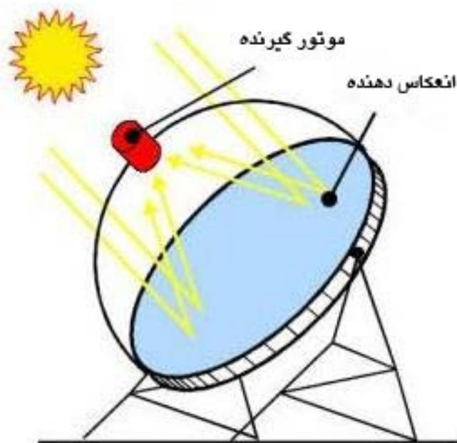
شکل (۹): شمای کلی از عملکرد دیش استرلینگ (گزارش CSP، آژانس بین‌المللی انرژی، ۲۰۱۲)
