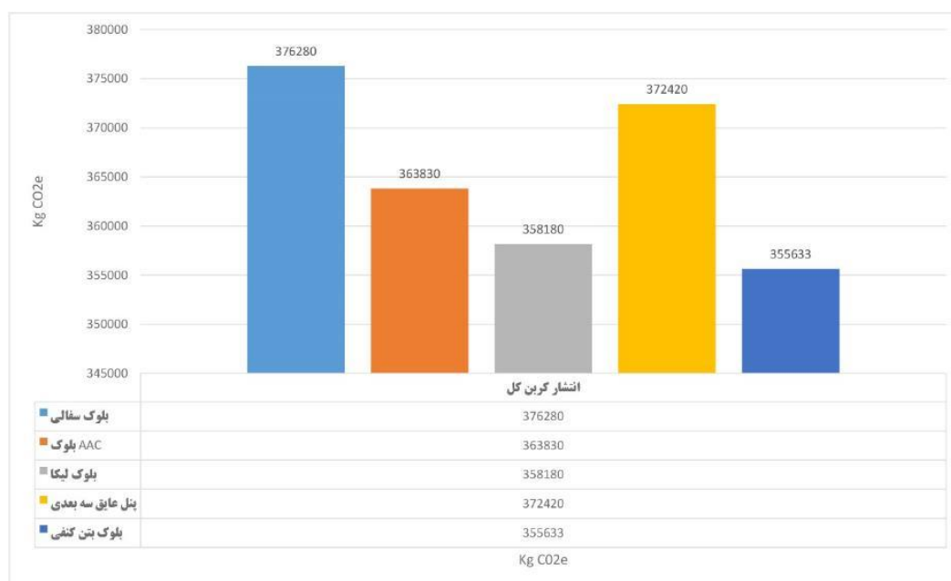
شکل ۱۹: میزان انتشار کربن کل در طول چرخه عمر ساختمان با استفاده از مصالح مورد بررسی
