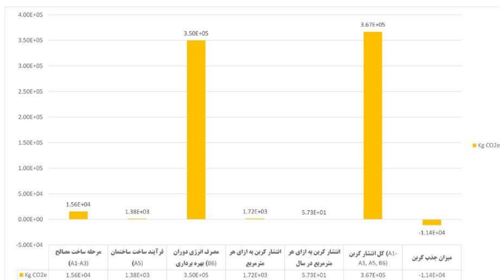
شکل ۱۵: میزان انتشار کربن نمونه مورد بررسی در مراحل مختلف (A1-A3, A5, B6) با استفاده از دیوار نوع پنجم (بلوک بتن کفنی و عایق کاه گندم)
