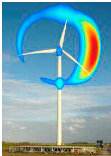
شکل ۲: نویز ایجاد شده یک توربین بادی در صفحه چرخش پره (Sedaghatizadeh et al., ۲۰۱۷)
