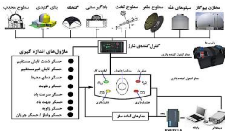
شکل ۱. طرح‌واره سامانه فتوولتایک منعطف و تجهیزات کنترلی
