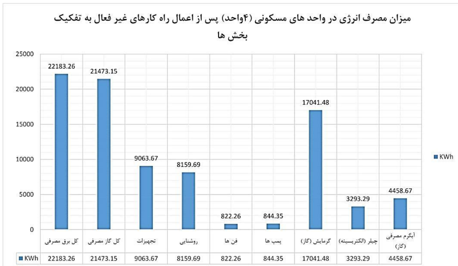
شکل ۸. میزان مصرف انرژی در واحد های مسکونی (۴ واحد) پس از اعمال راهکارهای غیرفعال به تفکیک بخش ها
