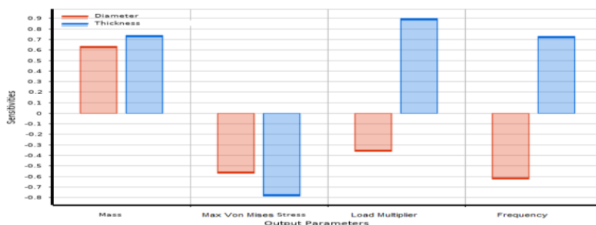
شکل ۱. تحلیل حساسیت توابع هدف و محدودیت‌ها بر حسب متغیرهای طراحی
