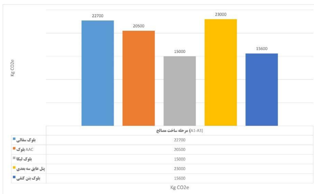
شکل ۱۶: میزان انتشار کربن ناشی از هر یک از مصالح مورد استفاده در مرحله گهواره تا دروازه (A1-A3)
